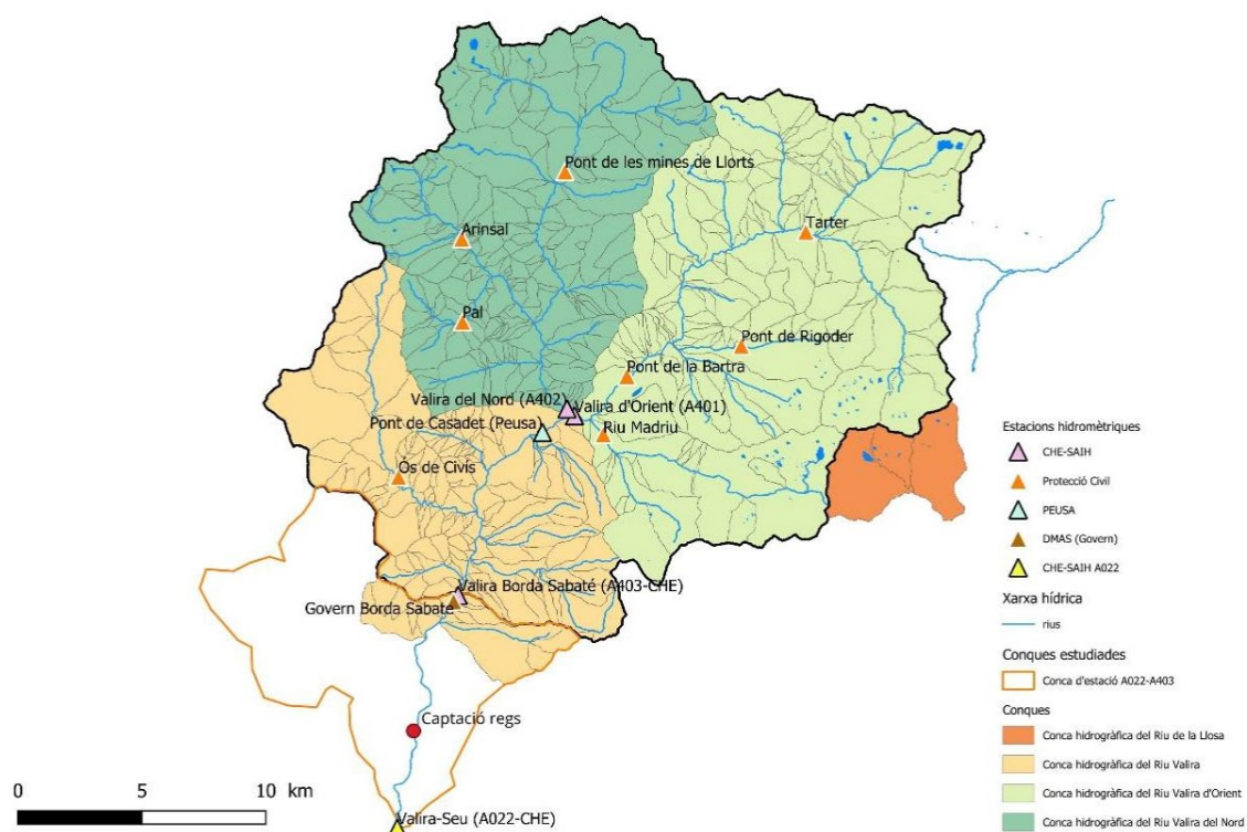
Figura 1. Ubicació de les estacions hidromètriques de mesura de calat i/o cabal a la conca de la Valira
