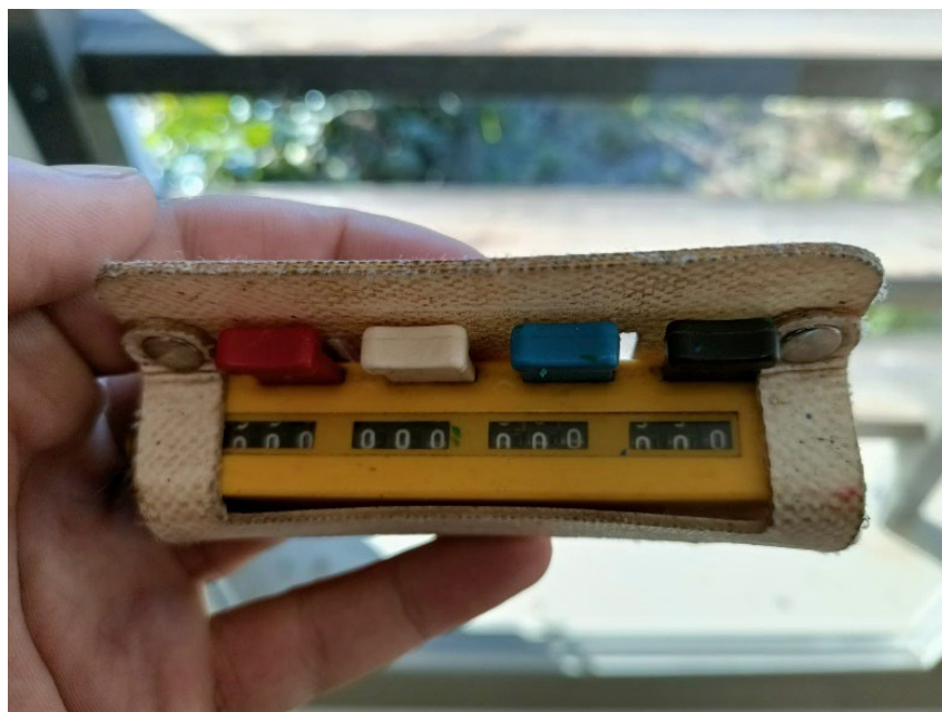
Figura 21. Comptador múltiple de pulsador per al compteig del regenerat. Elaboració pròpia.
