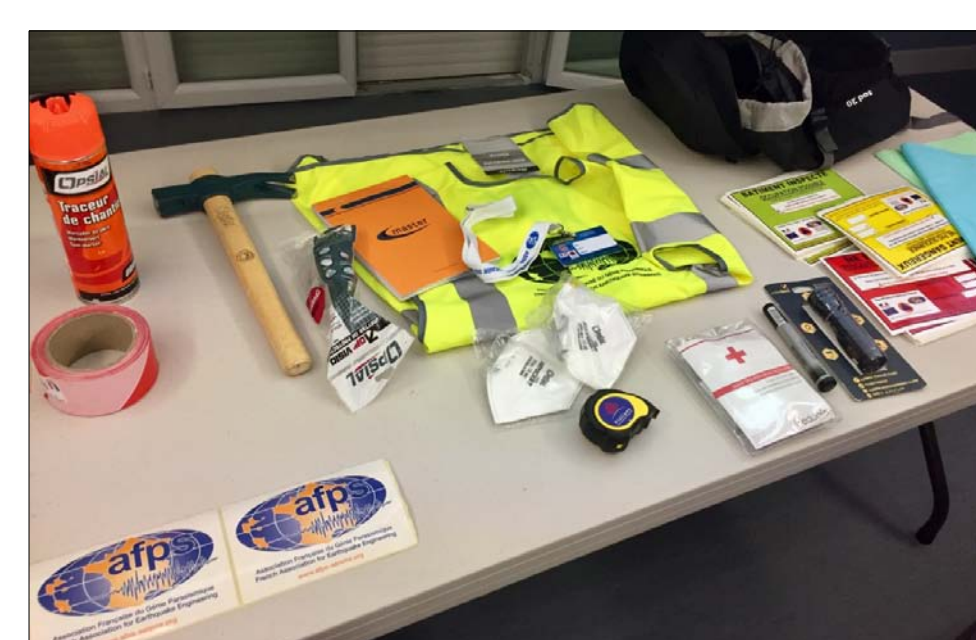
Photo 2. Matériel livré aux inspecteurs du dispositif « Urgence » de l'AFPS pour participer aux diagnostics de bâtiments en situation d'urgence post-sismique.
